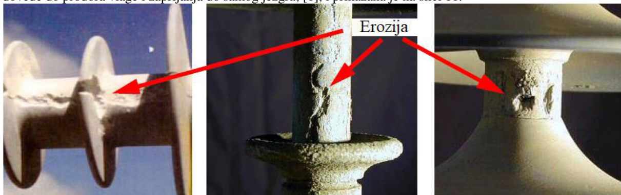
Slika 11. Prikaz kućišta kompozitnog izolatora posle pojave erozije [3]
