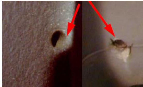
Slika 12. Prikaz rupa na kućištu kompozitnog izolatora koje su nastale kao posledica proboja [3]
