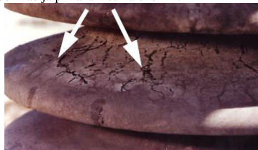
Slika 14. Prikaz stvaranja provodnih staza i karbonizacija [3]
