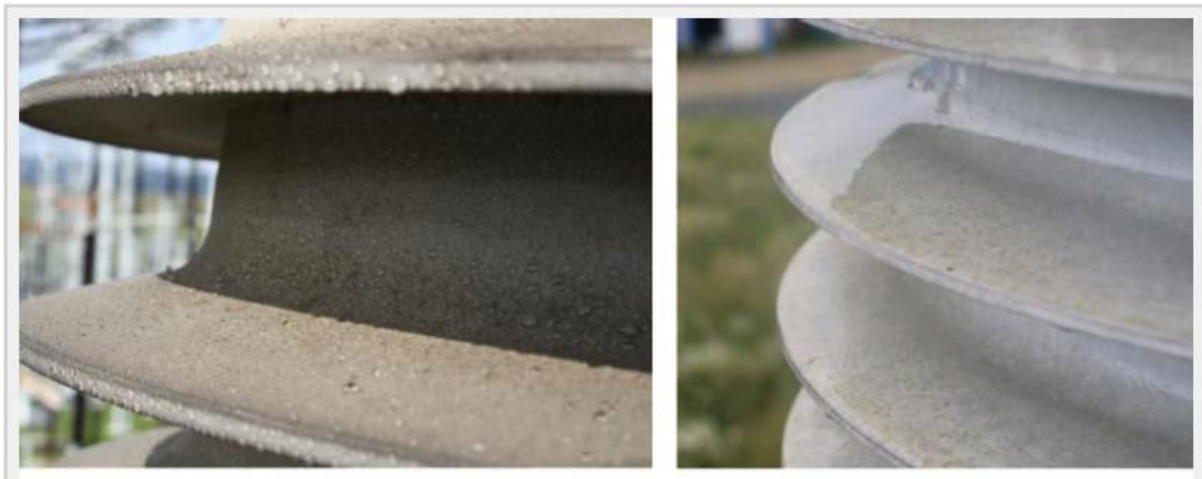
Slika 2. Uporedni prikaz hidrofobnosti kućišta kompozitnog izolatora gde nije došlo do degradacije (levo) i kućišta izolatora koje je izgubilo hidrofobnost zbog degradacije (desno) [2]
